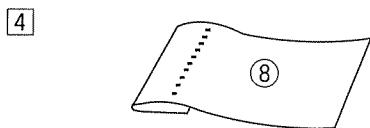
1 При работе с тяжелыми тканями, срезы которых могут осыпаться, сначала обработайте край. При работе с легкими и средними тканями заложите складку как показано на рисунке. Заложите складку и отверните ее назад с припуском в 0.5 см.
