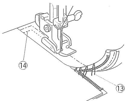
Поднимите лапку. Снимите ее и переставьте на левую сторону.
