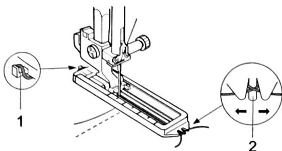
**1.** Поднимите лапку для петли, набросьте шнур на крючок сзади лапки.
