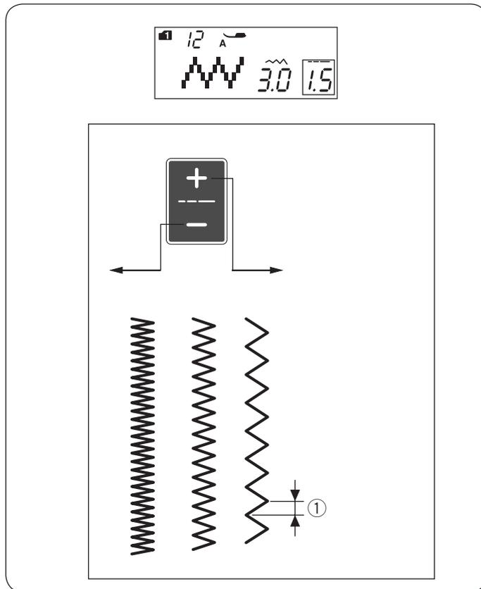
Стежок зигзаг используется при различных техниках шитья, включая шивание через край. Его можно применять для большинства вязаных тканей.
