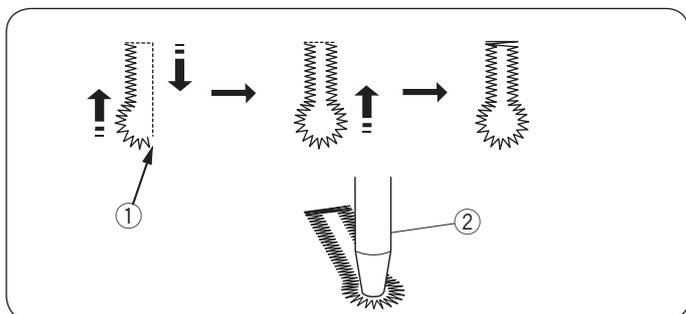
Порядок шитья аналогичен тому, что приведен для квадратных петель для пуговиц (см. стр. 49-51). Машина прошьет петлю в показанном порядке. Для раскрытия петли с глазком используйте пробойник.
