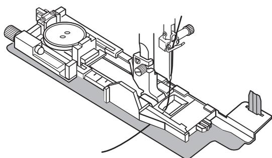
2 Положите пуговицу на держатель пуговиц на лапке. Установите лапку для петли-автомата на машину. Протяните игольную нить налево между лапкой и стабилизирующей пластиной.
