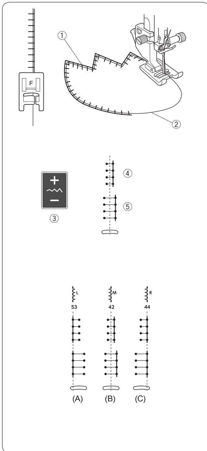
Расположите аппликацию на ткани и приметайте ее или используйте булавки, чтобы закрепить аппликацию.
