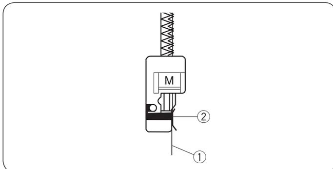
Этот стежок замечательно подходит для тканей, которые могут осыпаться, таких как лен и габардин. Два ряда стежков зигзагообразной строчки, одновременно прошитых поверх края, обеспечивают защиту ткани от осыпания.
