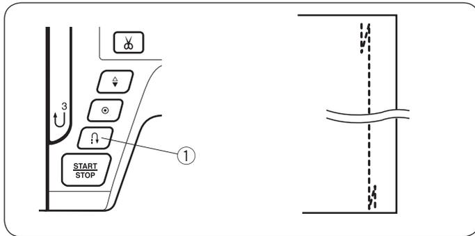
Используйте данный стежок для закрепления начала и конца шва реверсной строчкой. При достижении конца шва нажмите кнопку реверса ① один раз. Машина сделает четыре обратных стежка, четыре стежка вперед, а затем остановится автоматически.
