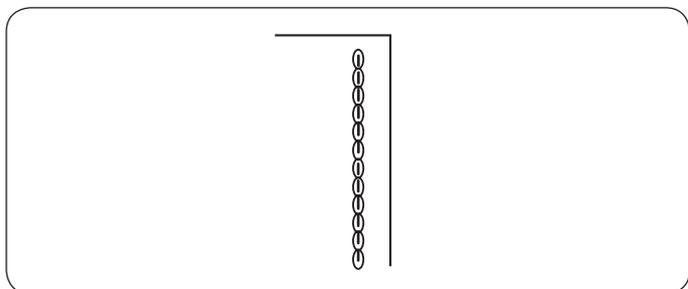
Этот прочный эластичный стежок рекомендуется применять там, где необходимы как эластичность, так и прочность. Используйте его для усиления швов в зонах проймы. Также используйте его при создании таких вещей, как рюкзаки, для придания большей прочности.
