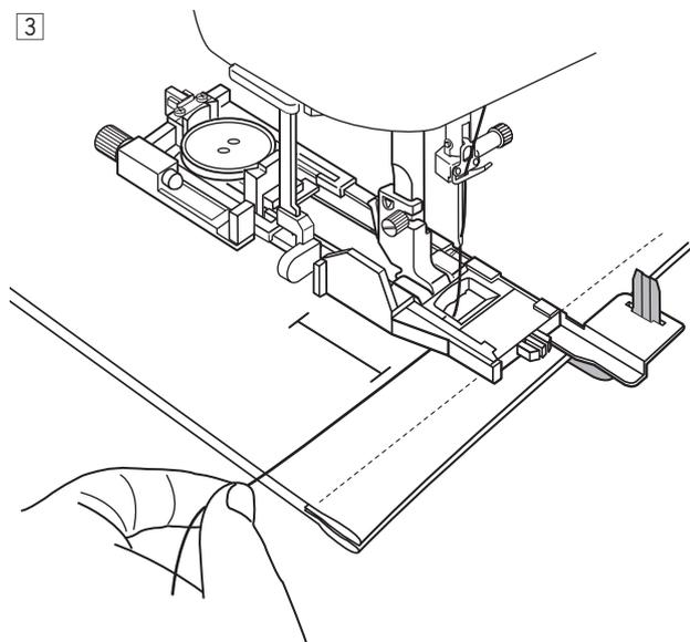
3 Вставьте ткань между лапкой для петли и стабилизирующей пластиной. Опустите иглу в точку начала, повернув маховое колесо. Опустите лапку и ограничитель петли. Запустите машину, немного отводя игольную нить влево. Прострочите несколько стежков, отпустите нить и продолжайте шить.
