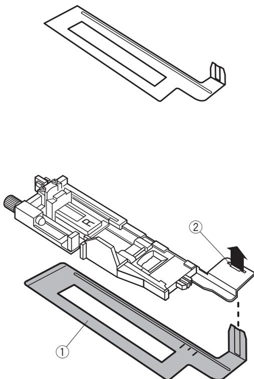
1 Вставьте выступ стабилизирующей пластины 1 в прорезь 2 лапки для петли-автомата.
