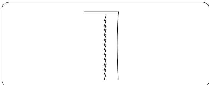
Этот узкий эластичный стежок разработан для уменьшения складок при шитье вязаных тканей и трикотажа, одновременно позволяя сделать шов плоским и полностью его раскрыть.
