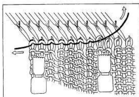
I. Выдвиньте иглы с петлями, предназначенными для убавления в первой фазе частичного вязания, в положение **D**, со стороны, противоположной каретке.
