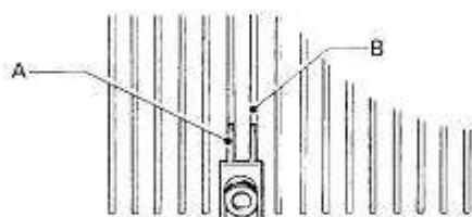
Установите краевые штырьки так, чтобы кнопки на них оказались между двумя последними работающими иглами с каждого края вязания.
