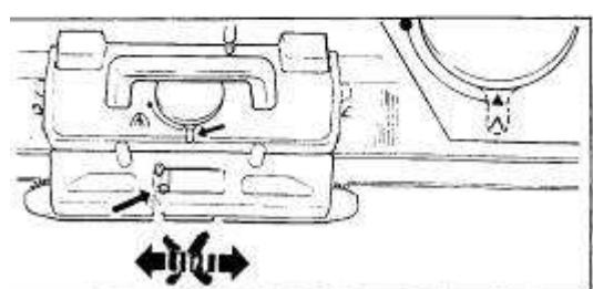
Не двигайте каретку без нити в нитеводителе, если ручка выбора узора установлена на  $\wedge$ , так как вязание будет сброшено с машины.
