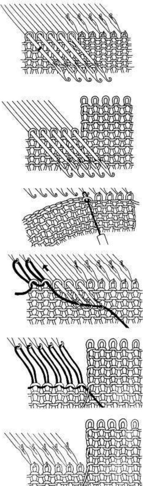
Фиксирование петель с помощью вспомогательной нити I (только для главной каретки)
