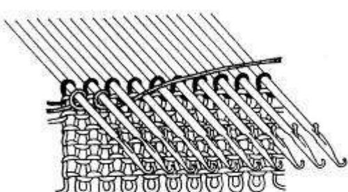
3. Начиная с крайней левой иглы, свяжите рабочей нитью стержни всех игл последовательно в направлении против часовой стрелки.
