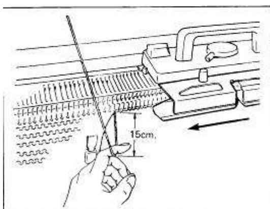
Для многократного перенесения петель или перенесения петель в разных направлениях перед провязыванием очередного ряда используйте каретку отдельно для деккеровки и для вязания.
